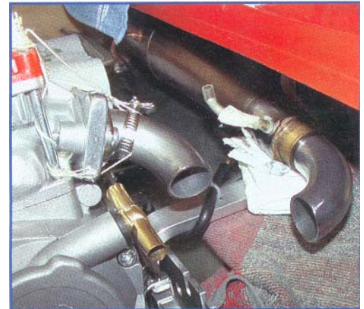
Einpassen des letzten Rohrstücks
