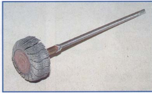
Fächerschleifer zum Verputzen der Schweißnähte im Rohr
